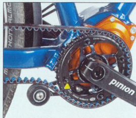
Eine Spannrolle am Getriebeblock erspart aufwendige, verschiebbare Ausfallenden und eventuelle Probleme damit.
