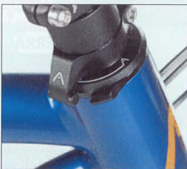
Hilfreich bei Lowrider-Beladung: Lenkeranschlag auf 90 Grad.
